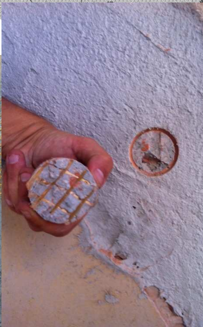
Fascio di fibre di PBO su mata rivolgate sul fronte est e ovest. Successiva rasatura, ripristino intonaco e riintegro facciata
